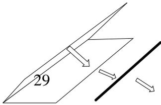
Teil 29 in der Mitte falzen und verkleben. Nach dem Austrocknen in ca. 1mm breite Streifen kleben und als Fahdraht entsprechend der Gleisführung unter die Querabspannungen und unter die Dachträger kleben.
